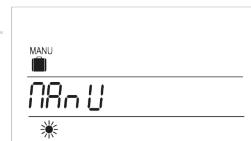
Stlačte tl. **MENU** a vyberte tl. **+ / -** režim **MANU ☀**, potvrdte tl. **MENU**; Na LCD bliká údaj o teplote, tl. **+ / -** nastavte požadovanú teplotu a potvrdte tl. **MENU**, ďalej nastavte hodinu, minúty, deň, mesiac a rok konca dovolenky, každé nastavenie potvrdte tl. **MENU**. Po nastavení dôjde k automatickému prechodu do režimu DOVOLENKA do 1 minúty! Na LCD sa zobrazuje dátum konca dovolenky!
