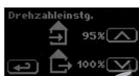
Nastavenie otáčok odvodu vzduchu
