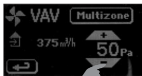
Nastavenie konštantného tlaku
