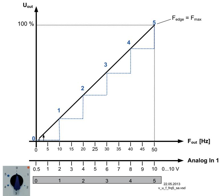
Analog In: Speed preset signal by 5-step switch
